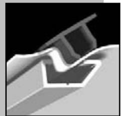
A l'aide du maillet anti-rebond, enfoncer le jonc pour réaliser la tension jusqu'au clipsage final.
