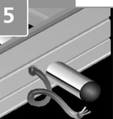
Faire sortir un câble électrique du cadre en installant un passe fil côté potences.
